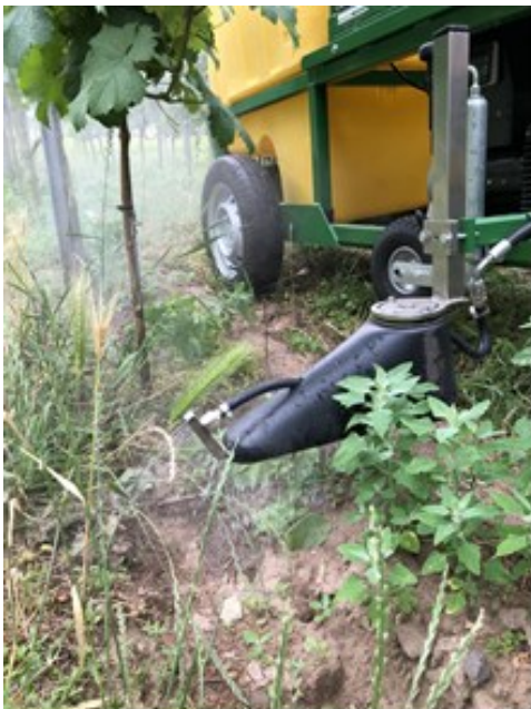
Abbildung 1 Heißwasserapplikation über Schwenkarm im Unterstockbereich (Firma Mantis in Kooperation mit der Fa. Ebinger).
