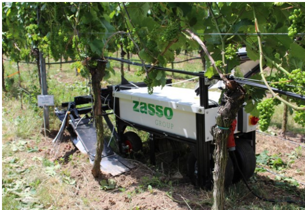
Abbildung 2: Handgeführtes Versuchsgerät der Fa. Zasso - die beiden Applikatoren ermöglichen den Stromfluss durch die Pflanzen.
